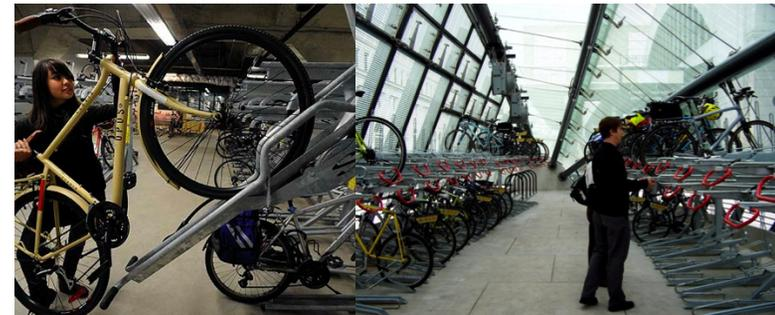
Figure 3-21 : Supports pour vélos à deux niveaux à une station de vélo. Sources : Tony Brock/Toronto Star (gauche) et BeyondDC (droite).
