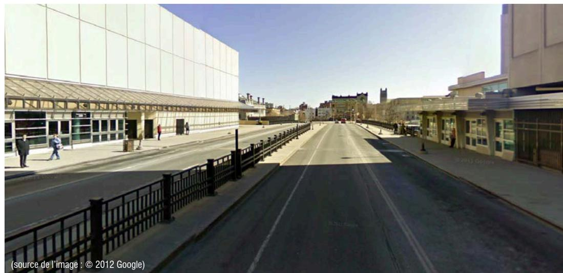
Ce projet témoin illustre la possibilité d'améliorer le confort des piétons et des cyclistes sur le pont Mackenzie King, tout en maintenant des installations adéquates pour le service d'autobus. Une installation cyclable bidirectionnelle occupe le centre du pont et la reconfiguration des voies d'autobus et de circulation permet de créer l'espace suffisant à la plantation d'arbres.
