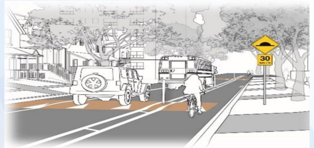
Speed humps / Dos d'âne allongés
