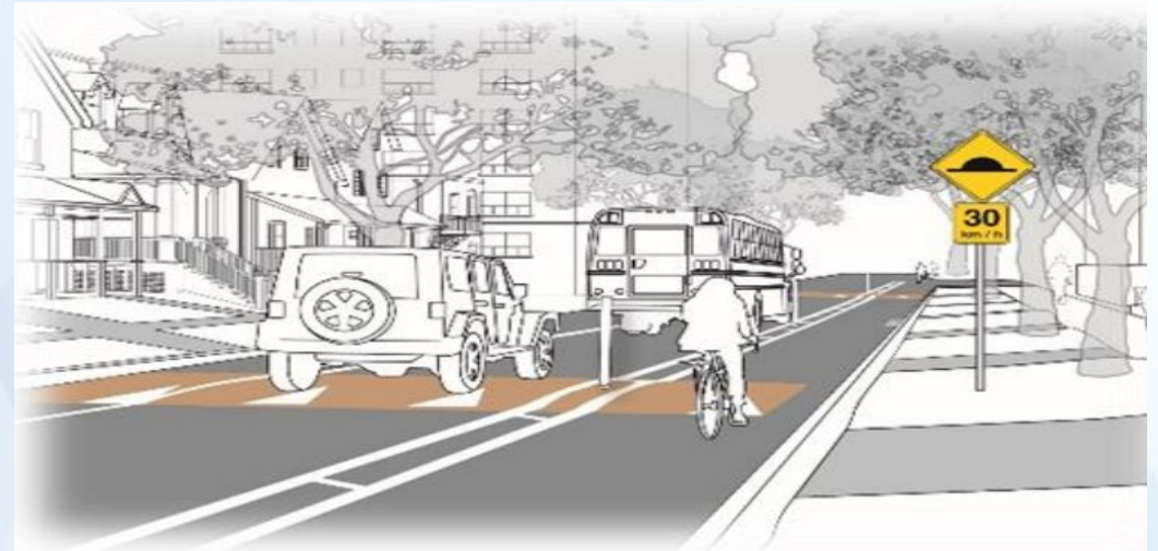
Speed humps / Dos d'âne allongés
