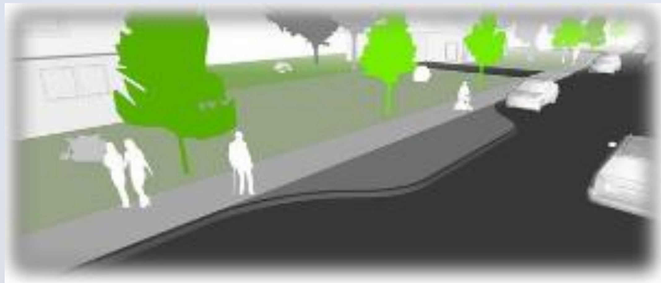
Mid-block narrowing (between 306 and 308 Ferndale) Rétrécissement à mi-pâté (entre le 306 et le 308, Ferndale)
