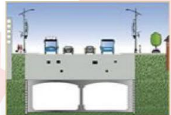
5. Enlèvement du tablier/ rétablissement de la rue
