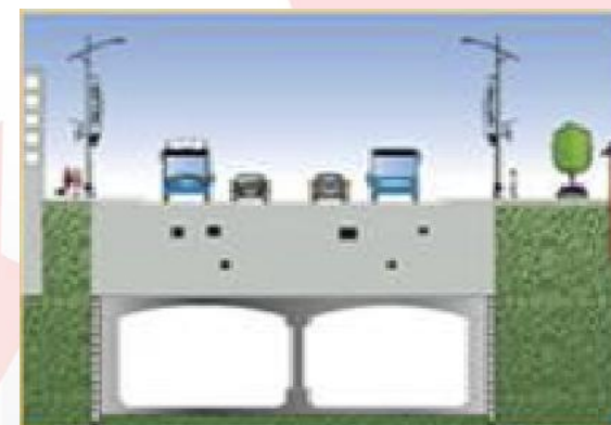
5. Enlèvement du tablier/ rétablissement de la rue
