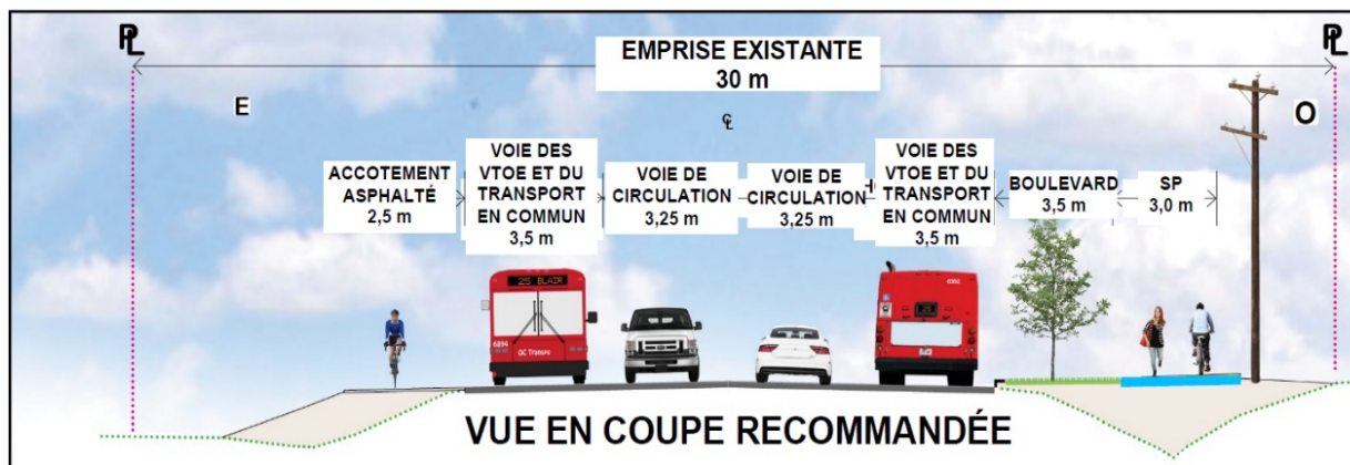
Figure EX-7 : Vue en coupe type du chemin Blair (au sud de la RO 174)
