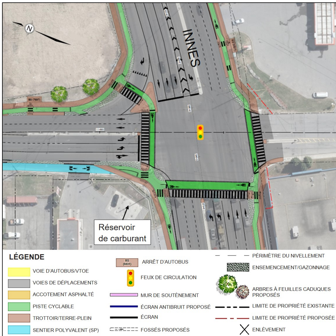
Figure EX-11 : Intersection protégée à l'angle du chemin Blair et du chemin Innes
