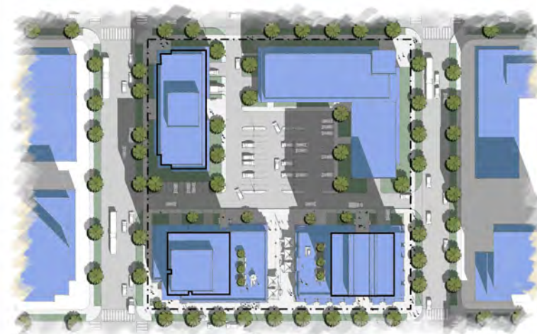
Diagramme 3-1 : Représentation conceptuelle de l'aménagement selon un plan directeur, dans lequel le stationnement est situé en sous sol et les autres places de stationnement, ainsi que les points d'embarquement et de débarquement sont situés à l'intérieur du site de l'aménagement.
