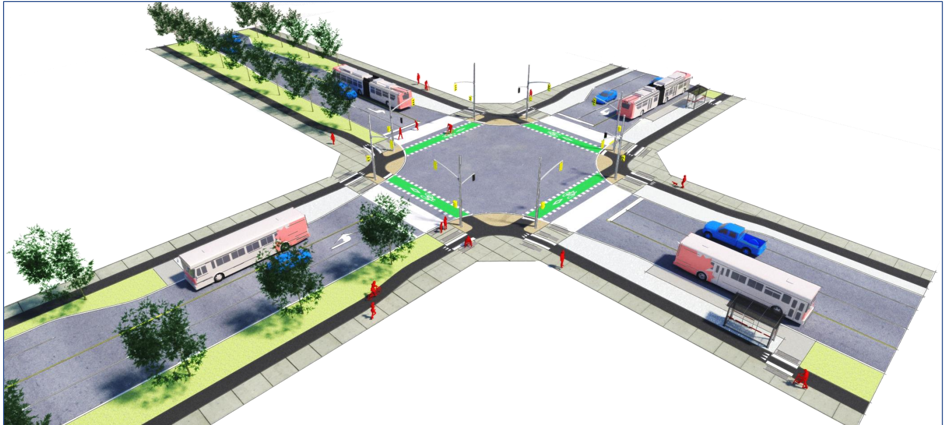
Figure 26 – Une intersection protégée distingue et clarifie l'espace occupé par tous les usagers
