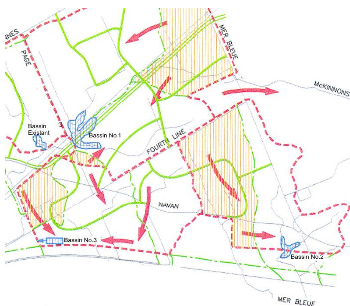
Figure 11 : Emplacements recommandés des bassins de gestion des eaux pluviales (Stantec Consulting Ltd., 2000, 2)
