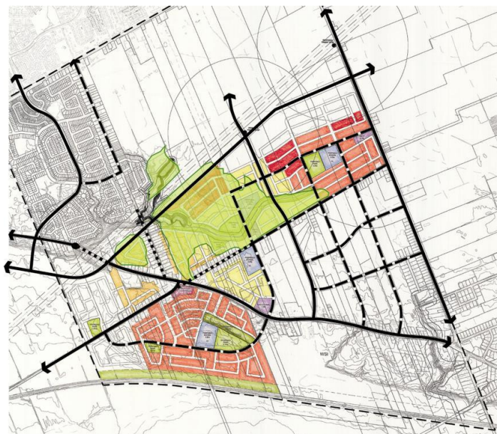
Figure 17 : Réseau provisoire et définitif d'artères et de routes collectrices. Les petits pointillés représentent les raccordements des chemins Renaud et Pagé au chemin Navan, qui demeureront ouverts jusqu'à ce que d'autres raccordements soient construits. Les lignes discontinues représentent le futur réseau de routes collectrices locales. Les lignes pleines correspondent aux artères nord-sud et est-ouest (chemins Mer Bleue et Navan, futur prolongement du boul. Belcourt, futur prolongement de la rocade de Blackburn Hamlet et boul. d'Orléans)
