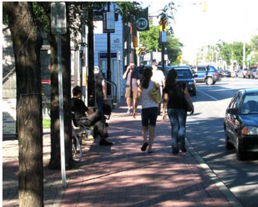
Figure 60b : Les commodités de cette rue sont disposées de manière à ne pas nuire au déplacement des piétons, y compris ceux se déplaçant en fauteuil roulant ou en triporteur.
