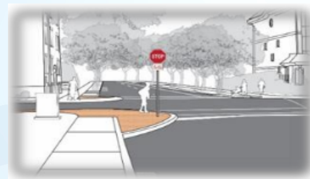
➤ Avancée de trottoir
