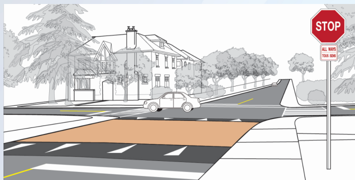
➤ Passage piétonnier surélevé
