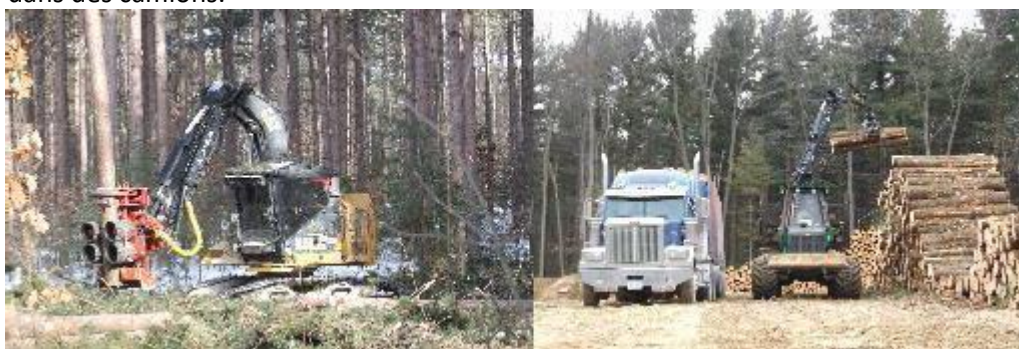
Figure 28. (À gauche) Une abatteuse-façonneuse à tête multifonctionnelle abat et transforme un pin rouge mature. (À droite) Un porteur transporte les produits jusqu'au point de débarquement et les charge sur un camion.
