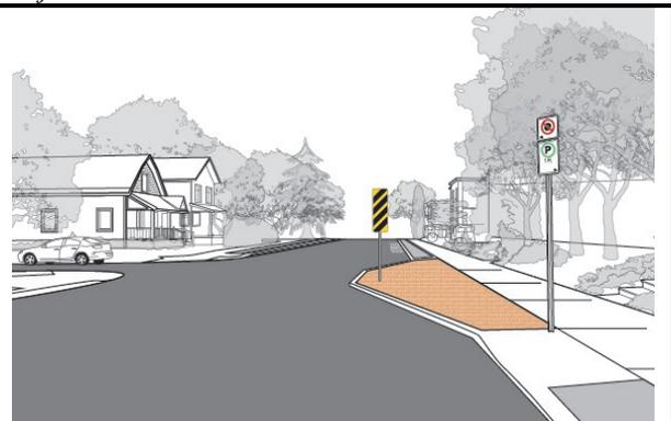
**Rétrécissements de la chaussée à mi-pâté** – Également appelés avancées de trottoir, ces éléments permettent de rétrécir les voies de circulation à mi-pâté.
