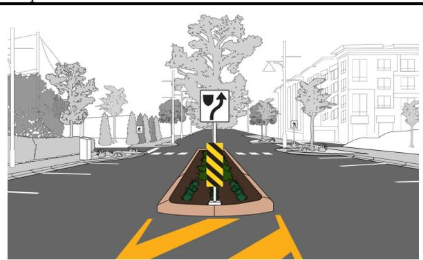
**Terre-pleins centraux** – Îlot surélevé en béton (ou peint) installé sur la médiane d'une route à deux voies qui diminue la largeur des voies de circulation adjacentes.
