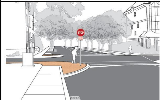
**Rétrécissements de l'intersection** – Également appelés avancées de trottoir, ces éléments permettent de rétrécir les voies de circulation aux intersections.
