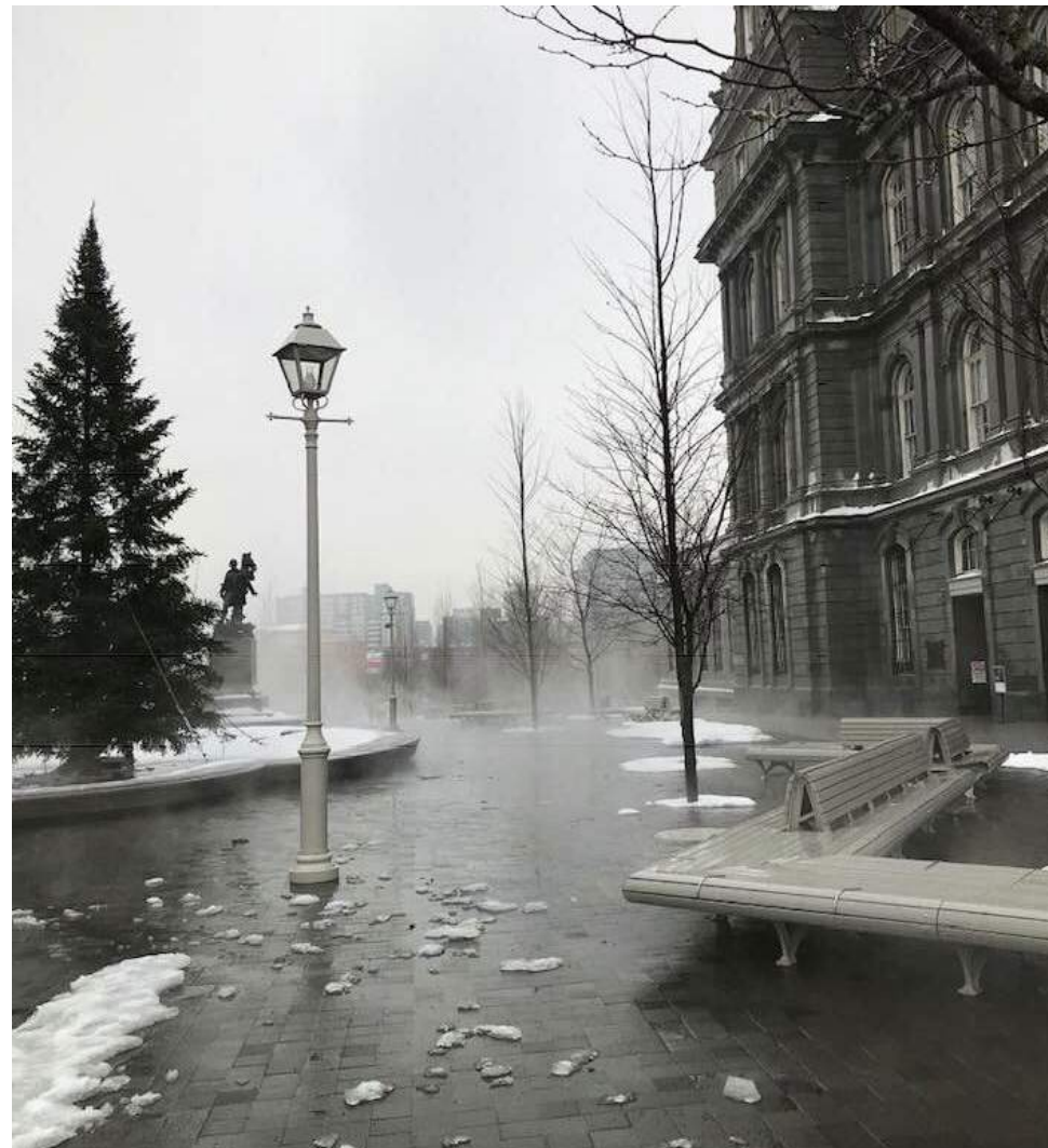
Fig. 138 Surface pavée chauffée à proximité de l'Hôtel de Ville de Montréal Source: Vlan
