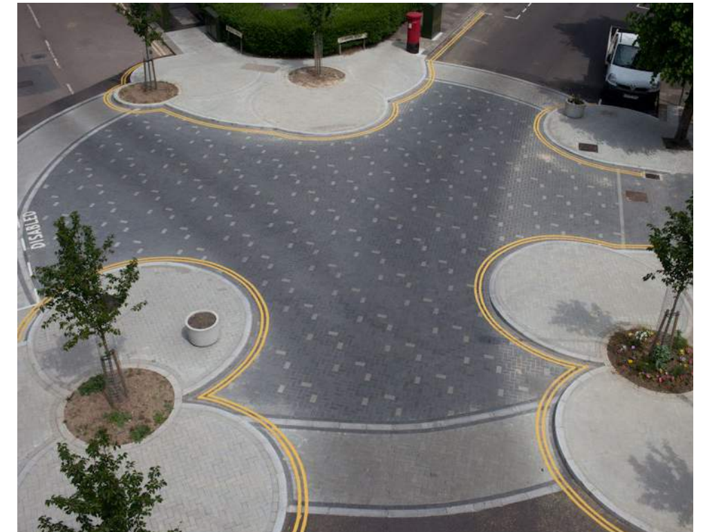
Fig. 31 Intersection surélevée avec traitement graphique Source: www.volkerwessels.co.uk/en/projects/detail/diy-streets-turnpike-lane-area-part-of-haringey-htm
