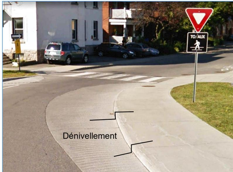
Figure 5 – Réduction visuelle du rayon d'angle avec une bordure franchissable
