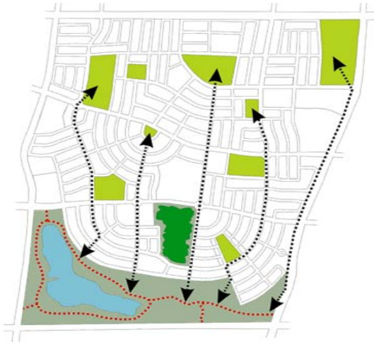
Figure 7a : Les bassins de gestion des eaux pluviales peuvent contribuer de manière importante au réseau général d'espaces verts.
