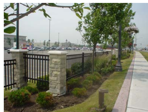
Figure 52b : Les aires paysagées d'une largeur d'au moins 3,0 mètres permettent une séparation visuelle et physique entre les aires de stationnement et les trottoirs publics.
