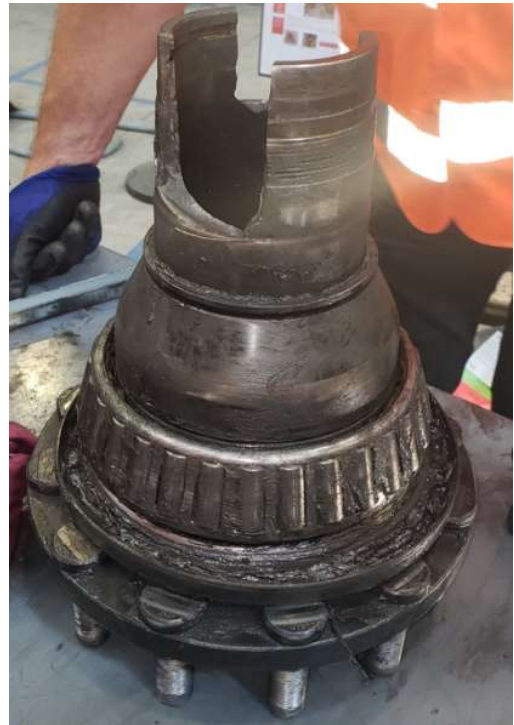
Figure 3. Moyeu d'essieu rompu du véhicule léger sur rail 1127 (Source : BST)
