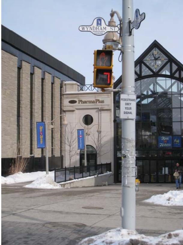
Décompte numérique pour piétons, en dessous du signal de la « MAIN FIXE » clignotant, indiquant le nombre de secondes qui restent avant qu'apparaisse le signal de la « MAIN FIXE ». Source : MMM Group
