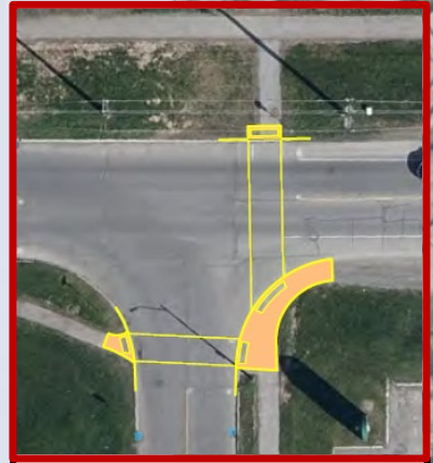
Plateformes d'arrêt piétonnier au ch. Johnston ouest
